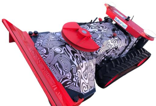
TECMA hat einen Prototyp eines ferngesteuerten Rasenmäroboters zur Pflege von Grünflächen unter bodenmontierten Photovoltaikanlagen entwickelt und konstruiert. Ausgestattet mit zwei beweglichen Vorderarmen, erreicht der Roboter das Gras präzise unter den Modulen und um die Stützmasten herum, wodurch die typischen Herausforderungen in solchen Umgebungen bewältigt werden.
