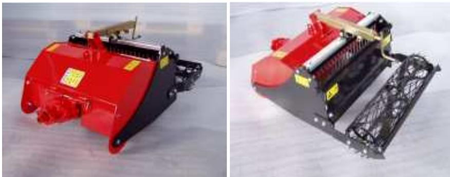
Umkehfräse zum Anbau an Einachser - Schlepper von 10 bis 14 PS. In einem einzigen Durchgang wird ein völlig ebenes Saatbett für Rasen (wie Parkanlagen oder Gärten), Gemüsebeete, Treibhäuser usw. vorbereitet. Mit einer Kurbel kann die Arbeitstiefe eingestellt werden. Darüber hinaus ermöglicht sie ein rasches und einfaches Umstellen von der Arbeitsposition in die Transportposition. Das Planierschiene hinten ist mit Hilfe von Knäufen höhenverstellbar.
