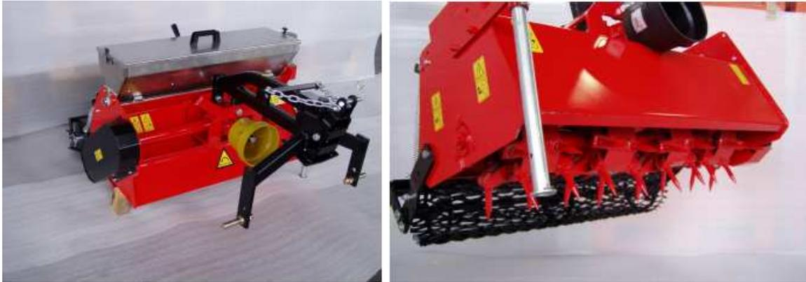
Der RYGEN ist ein Kombigerät, der bei einem Arbeitsgang mehrere Bearbeitungen durchführt, d.h. Rasen belüften, einsäen oder düngen und abwalzen.
